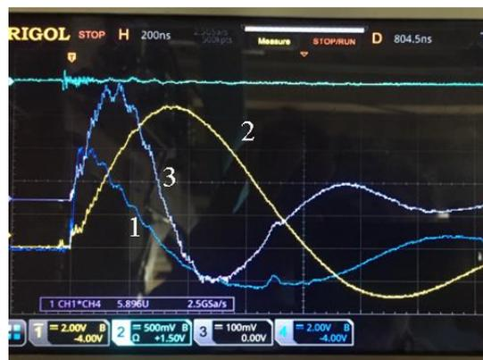
Рис. 20. Осциллограмма искрового разряда. 1 -  $U(t)$ ; 2 -  $I(t)$ ; 3 -  $P(t)$
