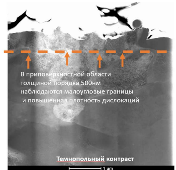
Рисунок 15 — Микроструктура образца, который был вырезан из центра кратера [204].
