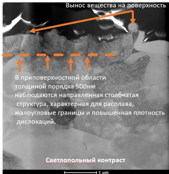
Рисунок 15 — Микроструктура образца, который был вырезан из центра кратера [204].
