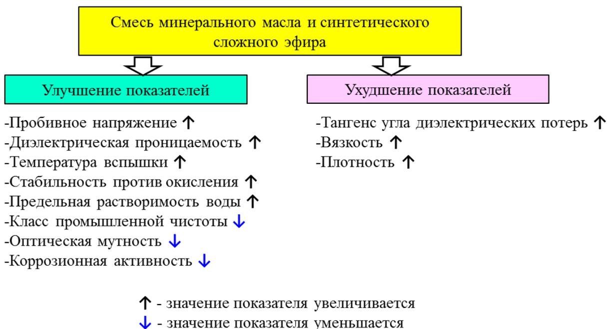
Рисунок 4.10 – Изменение характеристик минерального масла при добавлении в него синтетического сложного эфира на основании фактически измеренных данных
