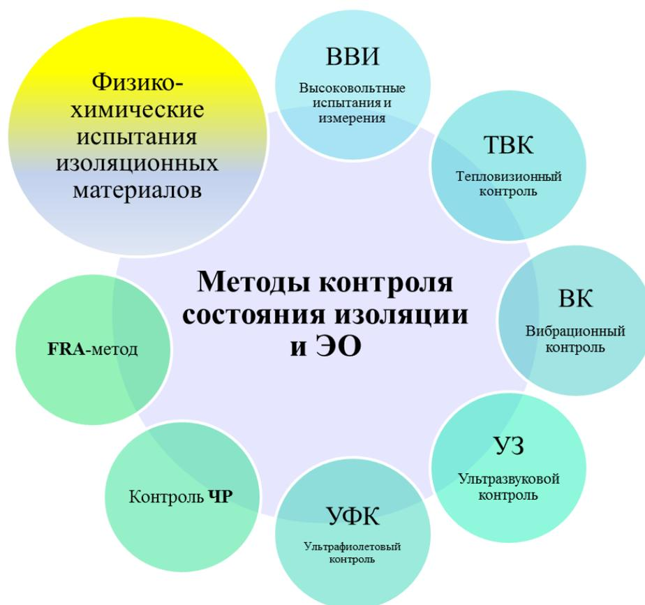
Рисунок 1.36 – Методы диагностики состояния изоляции электрооборудования
