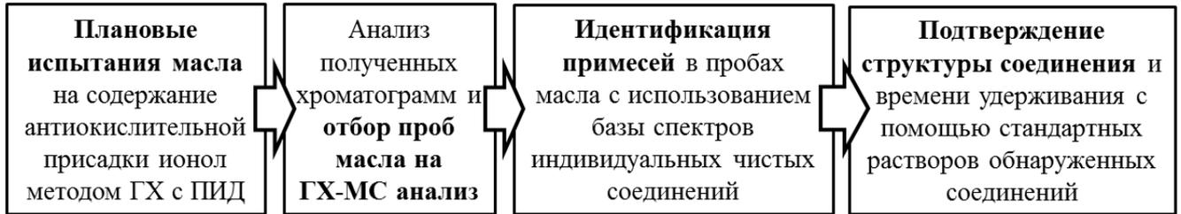
Рисунок 3.1 - Схема проведения эксперимента
