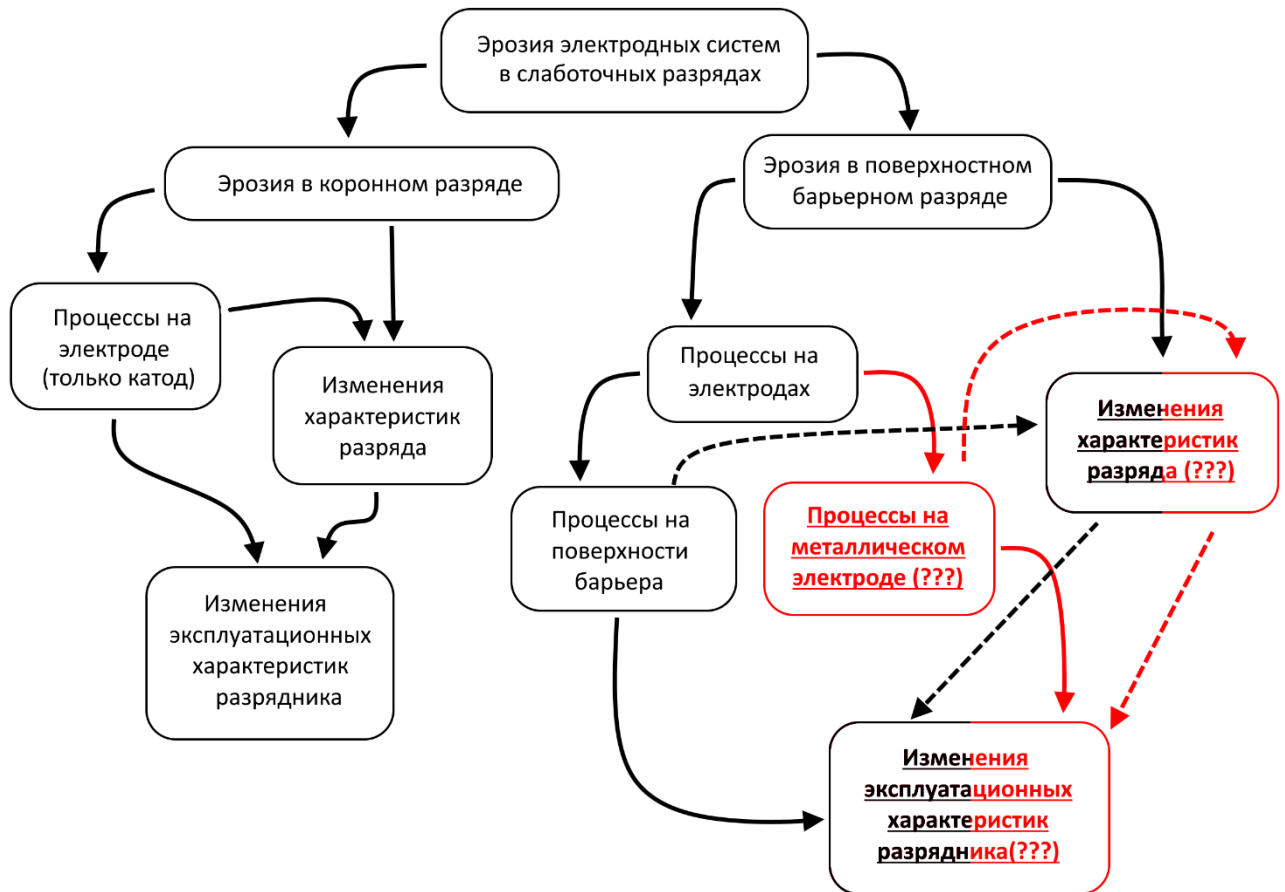
Рис. 1.38. Схематическое изображение представленного в литературе объема данных, посвященных исследованию деградации электродов в слаботочных импульсных разрядах. Сравняются близкие по параметрам коронный разряд и пДБР. Стрелками показано логическая последовательность описаний явлений. Красным цветом представлены практически не описанные аспекты деградации ДБР-разрядников.
