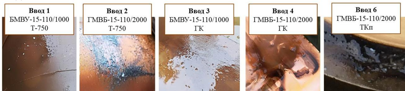
Рисунок 7 - Внешний вид отложений на различных частях высоковольтных вводов с БМИ напряжением 110-220 кВ
