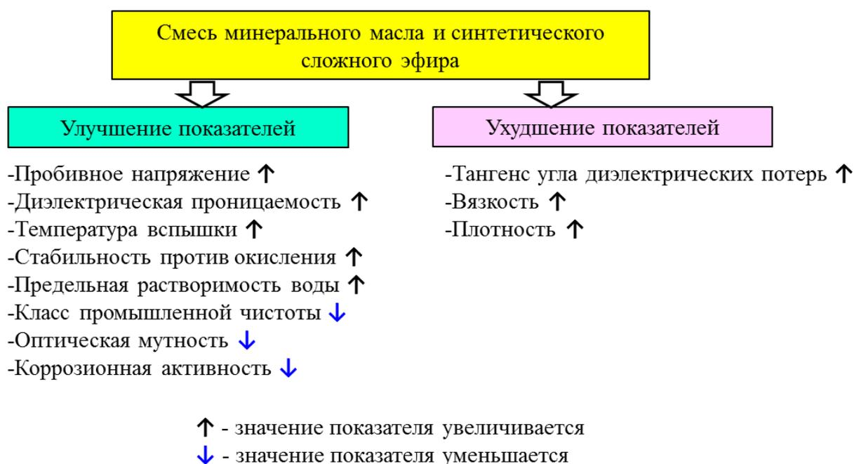
Рисунок 9 – Изменение характеристик минерального масла при добавлении синтетического сложного эфира
