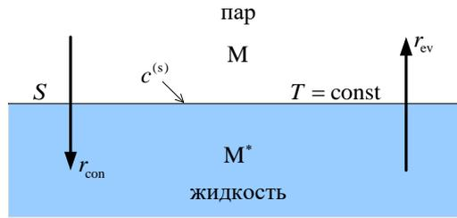
**Рис. 2.1.** Испарение/конденсация в системе жидкость–пар.
