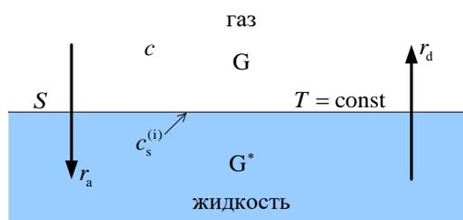
**Рис. 3.1.** Абсорбция/десорбция газа в системе газ–жидкость.
