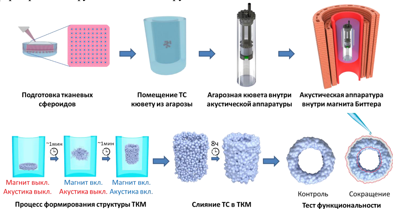
Рис.22 – Схема эксперимента по левитационной магнитоакустического формирования ТКМ из ТС
