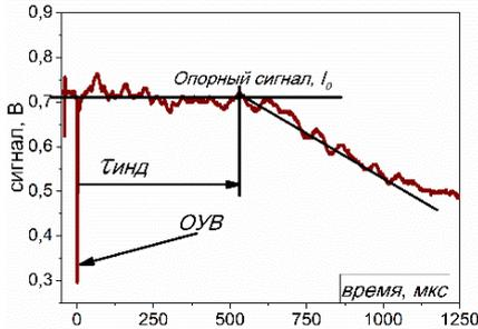
Рисунок 4. Осциллограмма экстинкции на длине волны 633 нм, полученная в смеси 5%  $C_2H_4$  в Ar, при  $T_{OVB} = 2195$  К.
