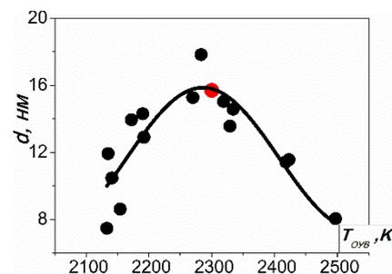
Рисунок 9. Температурная зависимость размеров углеродных наночастиц, полученная в смеси 5% $C_2H_4$  при времени измерений 1,5 мс.
