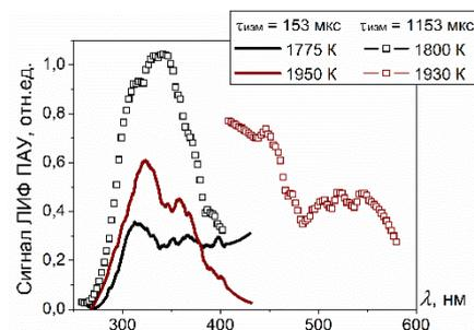
Рисунок 12. Спектры ЛИФ ПАУ, полученные при различных температурах и задержках времени измерений (сплошные кривые – 153 мкс, символы – 1153 мкс), в смеси 4% $C_2H_4$ +0,5% $C_4H_8O$ .
