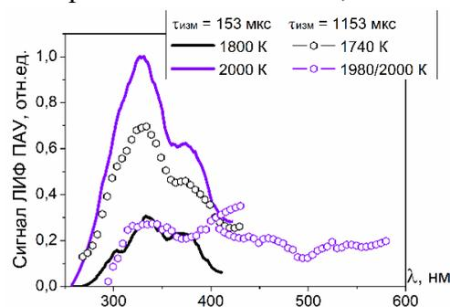
Рисунок 14. Спектры ЛИФ ПАУ полученные при различных температурах и задержках времени измерений (сплошные кривые – 153 мкс, символы – 1153 мкс), в смеси  $4\%C_2H_4+0,5\%C_2H_5OC_2H_5$ .
