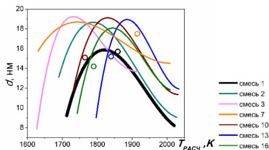
Рисунок 11. Температурная зависимость размеров образующихся углеродных наночастиц, измеренных методом ЛИИ, построенные от  $T_{РАСЧ}$ , при времени измерений 1,5 мс (кривые – аппроксимации наборов экспериментальных точек, точки – результаты измерений методом ПЭМ, черным – смесь 5% $C_2H_4$ , цветным – смеси с добавками: смесь 2 – бутанола, смесь 3 – метанола, смесь 7 – ТГФ, смесь 10 – ДМЭ, смесь 13 – ДЭЭ, смесь 16 – ДММ).
