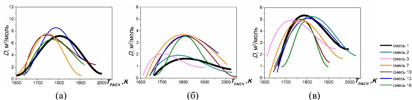
Рисунок 10. Температурные зависимости оптической плотности на 405 на (а) и 633 нм (б,в), построенные от  $T_{РАСЧ}$  при времени измерений 1мс (а,б) и 1,5 мс (в) (черным – смесь 5% $C_2H_4$ , цветным – смеси с добавками: смесь 2 – бутанола, смесь 3 – метанола, смесь 7 – ТГФ, смесь 10 – ДМЭ, смесь 13 – ДЭЭ, смесь 16 – ДММ, кривые – аппроксимации наборов экспериментальных точек).
