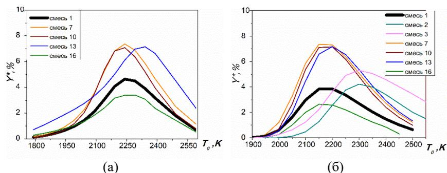
Рисунок 17. Температурные зависимости расчетного выхода крупных молекул ПАУ (а) и сажи (б) на момент измерений 1 мс (черным – смесь  $5\%C_2H_4$ , цветным – смеси с добавками: смесь 2 – бутанола, смесь 3 – метанола, смесь 7 – ТГФ, смесь 10 – ДМЭ, смесь 13 – ДЭЭ, смесь 16 – ДММ).
