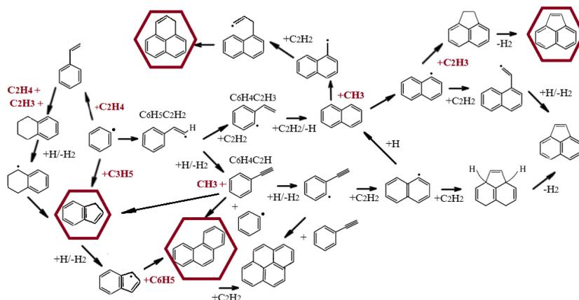
Рисунок 16. Схема образования и роста ПАУ, образующихся при пиролизе смеси  $5\%C_2H_4+95\%Ar$  (в рамку выделены ПАУ, образующиеся активнее в присутствии биотопливных добавок).
