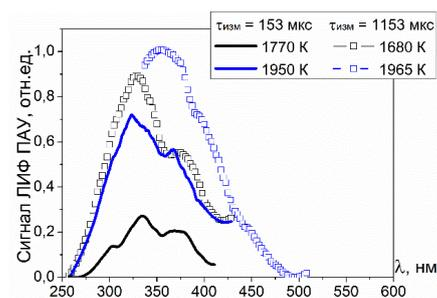
Рисунок 6. Спектры ЛИФ ПАУ, при различных температурах (обозначены в легенде) и задержках времени измерений (сплошные кривые – 153 мкс, символы – 1153 мкс), полученные в смеси  $5\%C_2H_4$ .
