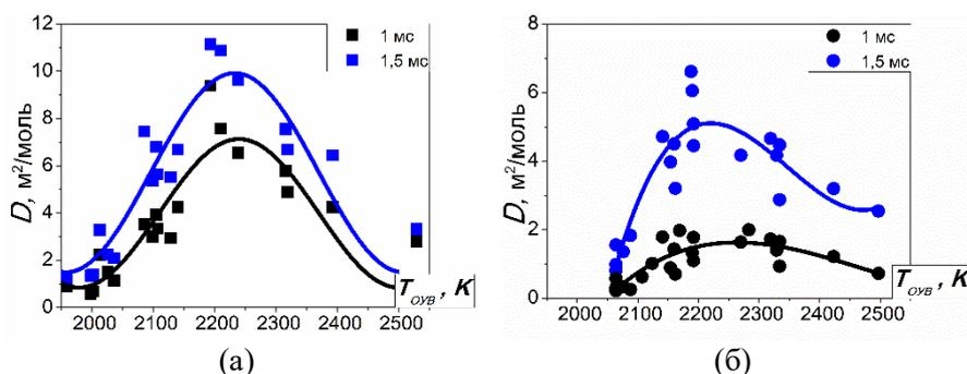
Рисунок 7. Температурные зависимости оптической плотности на длинах волн 405 нм (а) и 633 нм (б), при времени измерений 1 и 1,5 мс, полученные в смеси 5% $C_2H_4$ .
