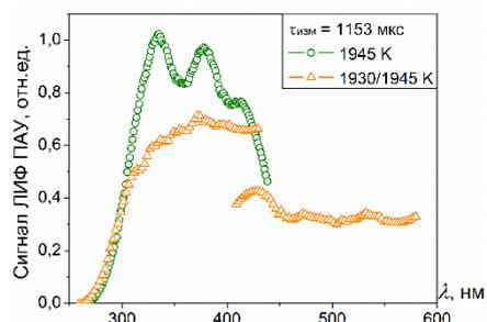
Рисунок 13. Спектры ЛИФ ПАУ, полученные при  $T_{OUB} \sim 1930-1945$  К и задержке времени измерений 1153 мкс, в смесях  $4\%C_2H_4 + 1\%CH_3OCH_3$  – зеленым, и  $4\%C_2H_4 + 0,7\%CH_3OCH_2OCH_3$  – оранжевым.
