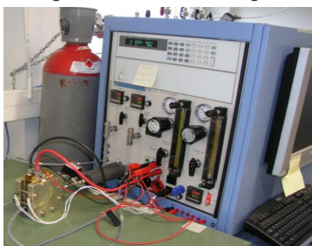
Рисунок 7 – Автоматизированная система испытаний ТПТЭ на базе установки BANC TEST фирмы Fuel cell technologies, Inc
