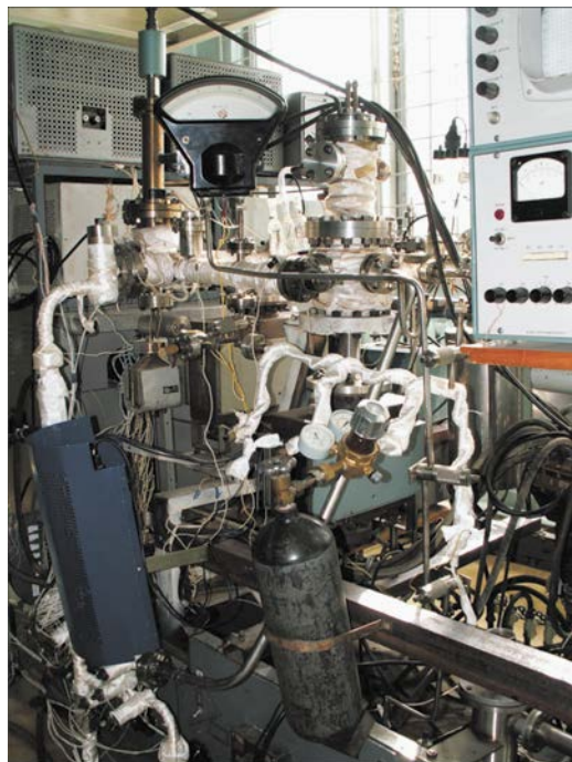
Рис. 3. Экспериментальный вакуумный стенд, оснащённый вспомогательными системами для подачи в межэлектродный зазор ТЭП цезия, различных инертных и активных газов.
