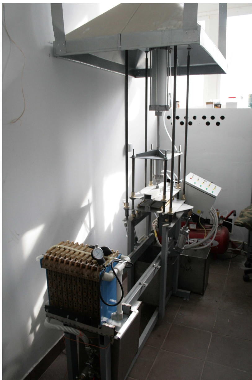
Рисунок 3 – Стенд для проведения гидравлических испытаний.
