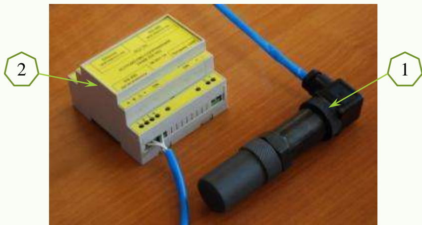
1 - датчик влажности, 2 - модуль сопряжения, к которому можно подключать до 16 датчиков влажности.
