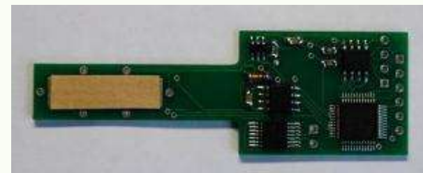
Влагодчувствительный элемент датчика влажности из трансформаторного картона толщиной 0,5 мм Емкость измеряется с погрешностью 1 фФ ( 10^{-15} Ф)
