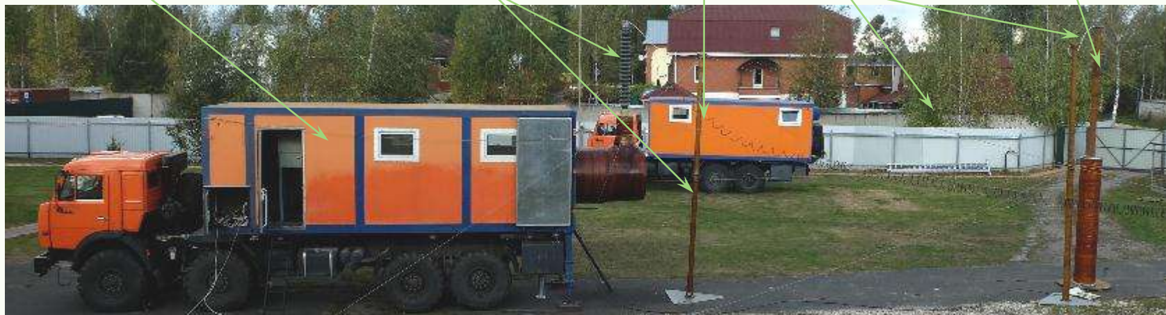
МИК ВМГ на площадке ШФ ОИВТ РАН, октябрь 2017, Сопrotивление активной нагрузки - 10 Ом, индуктивность контура - 150 мкГн
