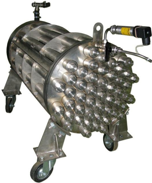
Металлогидридный накопитель РХ-1. Загрузка до 100 кг сплава. Емкость более 13 н.м 3 водорода
