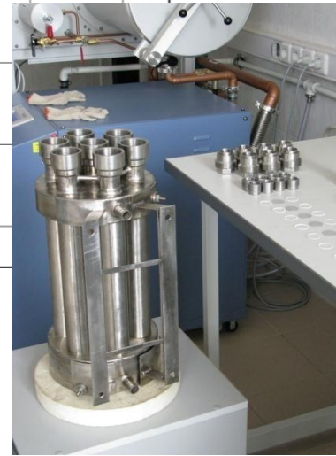
Реактор очистки и хранения водорода РХО-3. Загрузка до 5 кг сплава. Емкость более 800 н.л водорода
