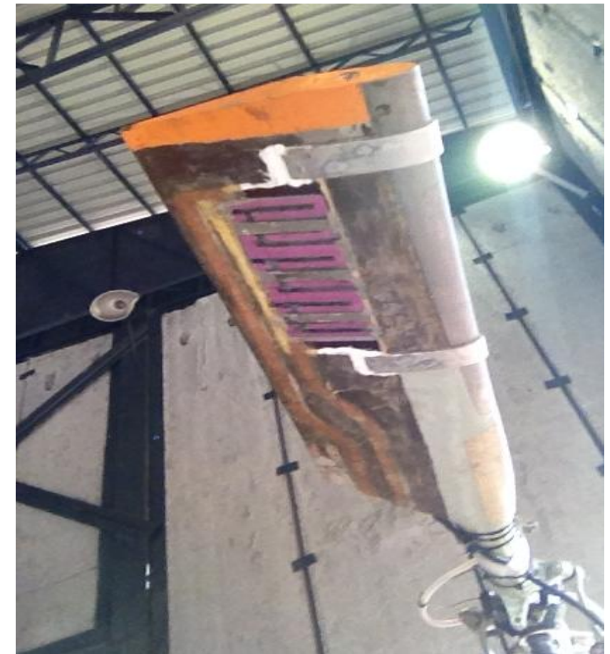
Фотография лопасти винта с установленными плазменными актуаторами на стенде
