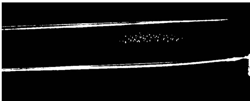
Рис. 16. Структура из частиц \text{Al}_2\text{O}_3 , в линейной ловушке в плазме коронного разряда. U_A = 7 кВ, f = 50 Гц.
