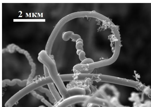
Рис. 8 СЭМ - изображение углеродных волокон, полученных при разложении ацетилена в аргоновой плазме при 150 Торр.
