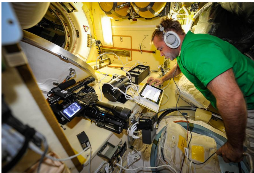
Рисунок 6.4 – Размещение блоков научной аппаратуры «КУК» в Российском сегменте МКС. М.В. Сураев выполняет сеанс эксперимента "Кулоновский кристалл".
