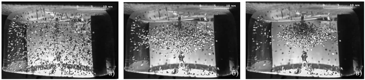
Рисунок 6.6 – Формирование структуры частицами графита размером 300 мкм при включении антипробкотронного магнитного поля а) 0 сек, б) 5 сек, в) 10 сек.
