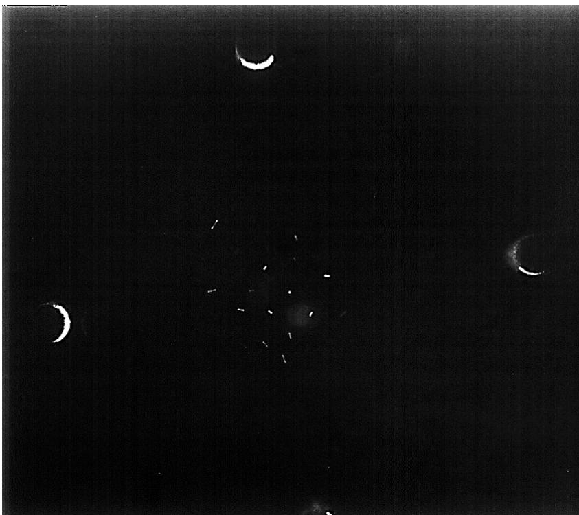
Рисунок 56. Пылевая структура в квадрупольной линейной электродинамической ловушке. Амплитуда переменного напряжения  $U_A = 4,25$  кВ,  $f = 130$  Гц.
