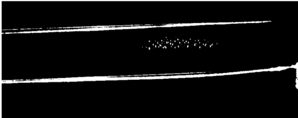
Рисунок 81. Устойчивая структура частиц в электродинамической ловушке с коронирующими электродами.
