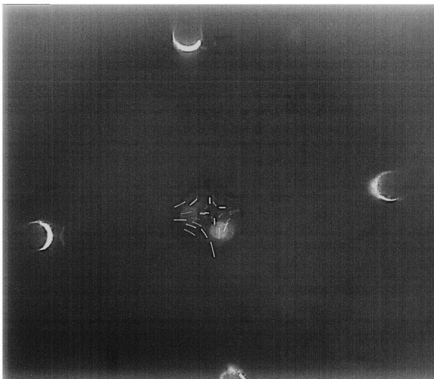
Рисунок 52. Пылевая структура в квадрупольной линейной электродинамической ловушке. Амплитуда переменного напряжения  $U_A = 4,25$  кВ,  $f = 50$  Гц.
