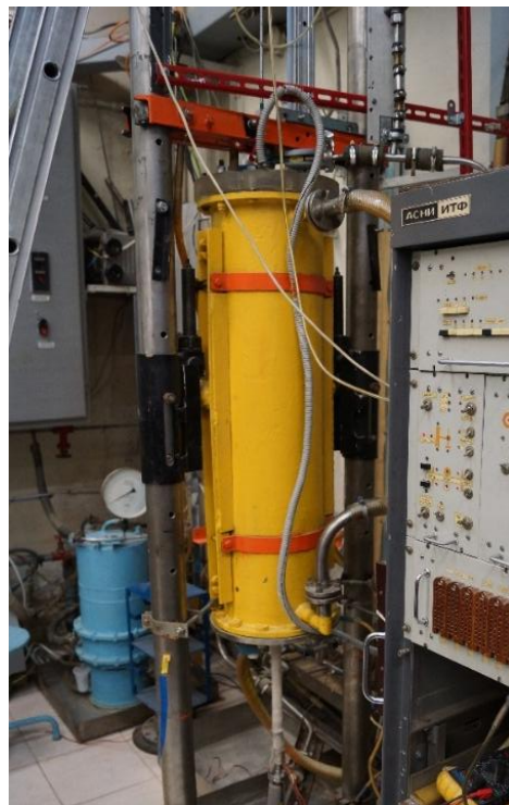
Рисунок 2.2. Экспериментальный стенд МЭИ для исследования гидродинамики и теплообмена ЖМ в ПМП
