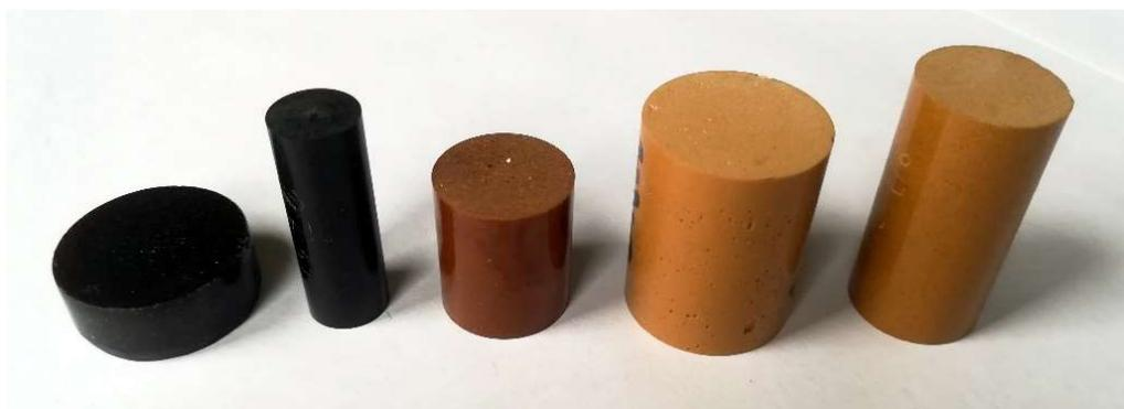
Рис. 19. Фотография цилиндров из эпоксидной смолы (1-й и 2-й слева), СФ27 (центральный) и СФ55 (1-й и 2-й справа).
