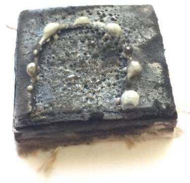
Рисунок 3.32 – Покрытие ТПТ после нагрева поверхности до 1470 °С при \alpha = 1,1 в течение 60 с
