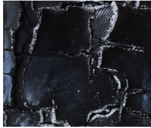
Рисунок 3.27 – Внешний вид образца СТР-КМ в исходном виде (а) и после высокотемпературных воздействий (б)
