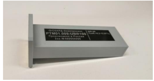
Рисунок 4.11 – Внешний вид образцов вставок из РПМ на основе феррооксида РАН-89 для волновода WR-159 (а) и конструктивное исполнение ВСН типа WR-90 (б)
