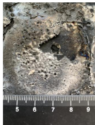
Рисунок 3.30 – Покрытие ТПТ после нагрева до 1000 °С при \alpha = 1,1 в течение 120 с
