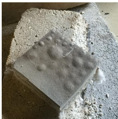
Рисунок 3.29 – Покрытие ТПТ после нагрева поверхности до 400 °С при \alpha = 1,1 в течение 45 с
