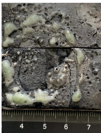
Рисунок 3.33 – Покрытие ТПТ после нагрева поверхности до 1850 °С при \alpha = 1,1 в течение 180 с
