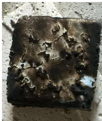
Рисунок 3.31 – Покрытие ТПТ после нагрева поверхности до 1250 °С при \alpha = 0,95 в течение 60 с
