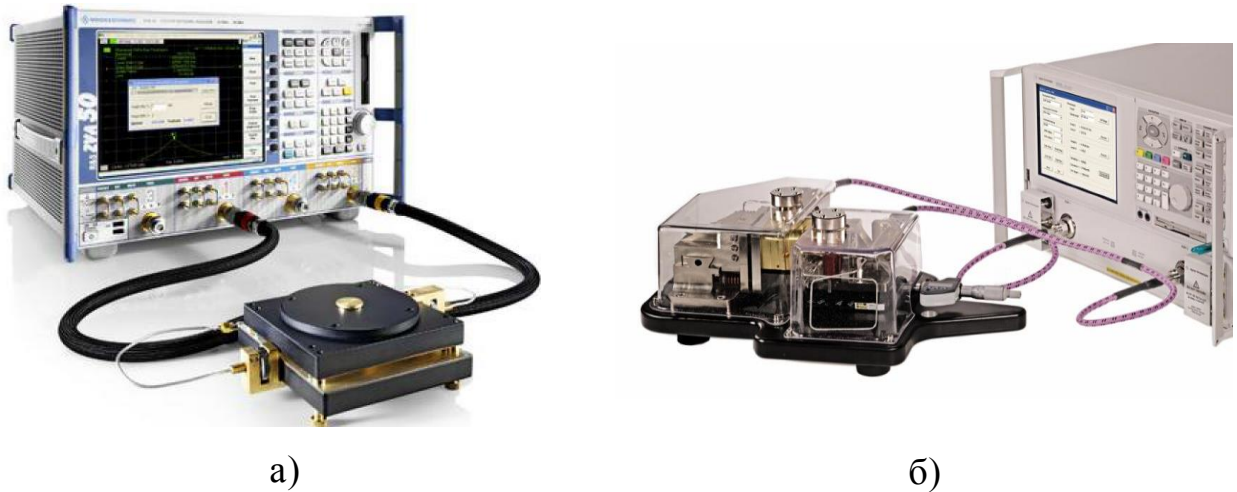
Рисунок 1.1 – Техническое исполнение резонаторного метода измерения параметров материалов на базе ВАЦ Rohde & Schwarz (а) и Keysight (б)
