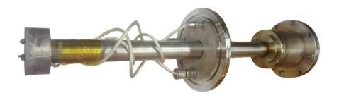
Рис. 2.2. Фотография созданного времяпролетного масс-спектрометра.
