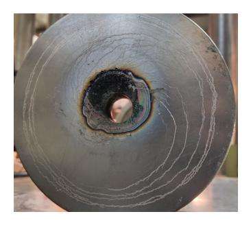
Рис. 5.6. Фотография стороны держателя магнитов, обращенной в плазму. Темное пятно в центре – пленка диоксида церия, сформировавшаяся в процессе горения разряда
