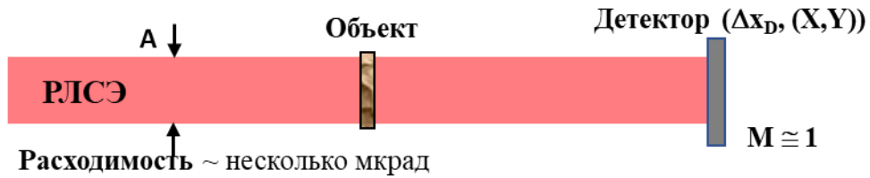
Рисунок 3.3 – Схема рентгенографии с использованием параллельного пучка РЛСЭ.
