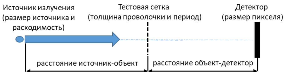
Рисунок 2.14 - Параметры, определяющие геометрию эксперимента по изучению волновых свойств рентгеновского излучения дифракционным методом [44].
