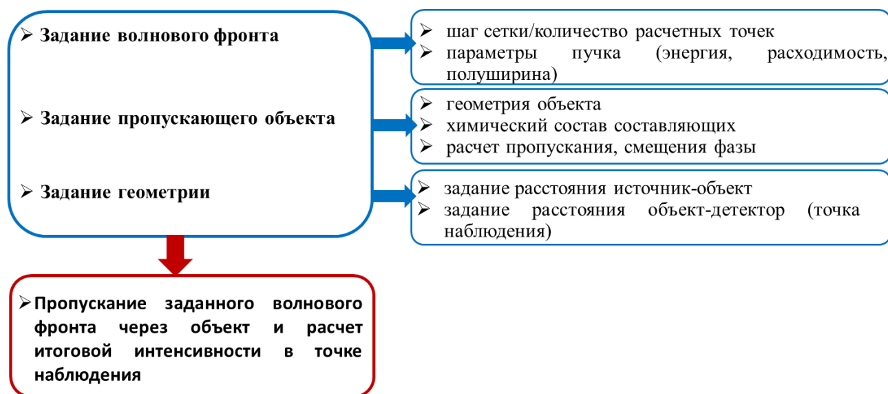
Рисунок 2.15 - Схема расчета дифрагирующего излучения при помощи среды WavePropagator.
