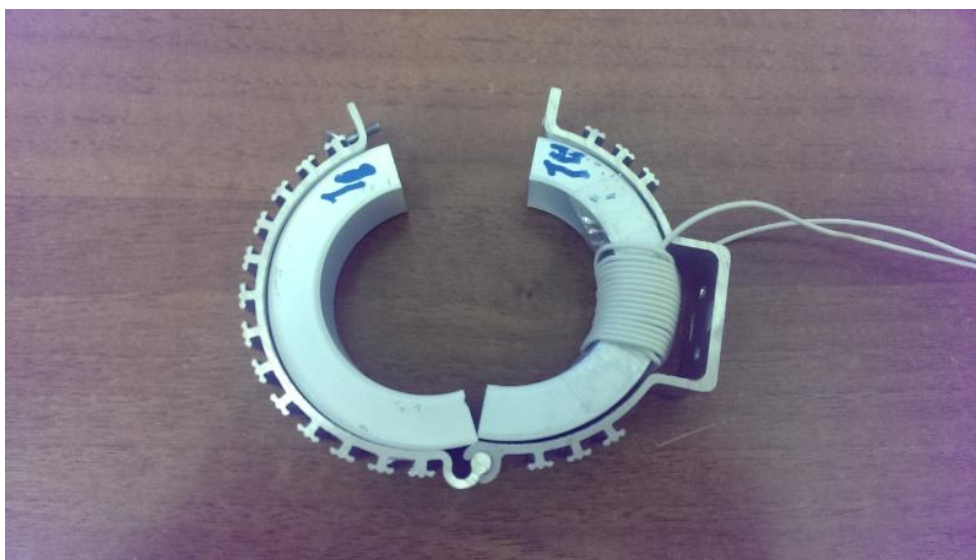
Рис. 3.3 Внешний вид кольцевого магнитопровода с намотанным на него индуктором.
