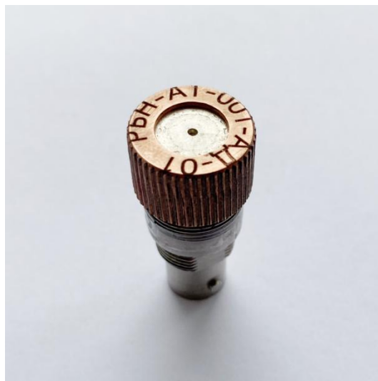
Рисунок 1.4(2): Общий вид детектора на основе монокристалла алмаза
