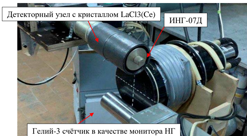
Рис. 3.4(2): Фотография размещения детекторного узла в прямой видимости мишени нейтронного генератора ИНГ-07Д.
