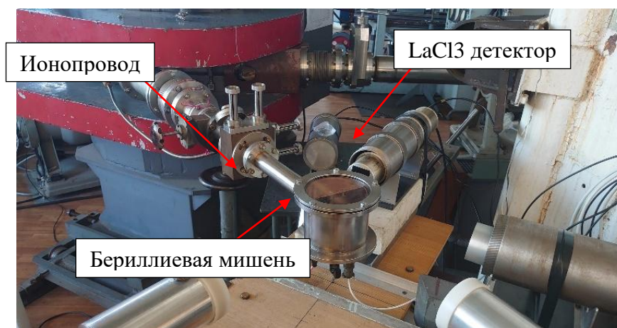
Рис. 3.4(8): Схема эксперимента для облучения детектора \text{LaCl}_3(\text{Ce}) на установке «Циклотрон ФТИ им. А.Ф. Иоффе»
