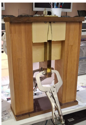
Рисунок 5.1 — Схемы и фотографии открытых симметричных полосковых измерительных ячеек различного поперечного размера
