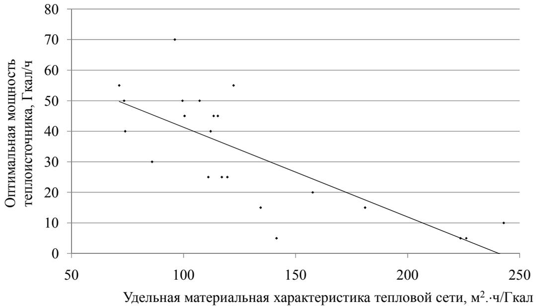
Рисунок 4.4 – Зависимость оптимальной мощности теплоисточников от удельной материальной характеристики тепловой сети (критерий – капитальные затраты)
