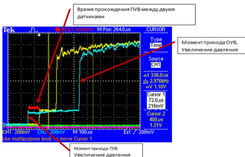
Рис. 1. Осциллограмма с датчиков давления, установленных в ударной трубе
