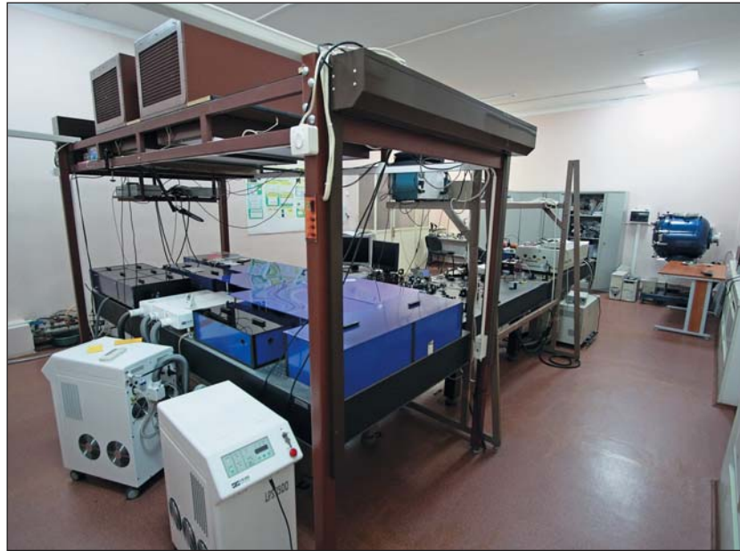
Фемтосекундная тераваттная лазерная система инфракрасного диапазона излучения на основе активного элемента хром-форстерит, созданная в 2002 г. в ОИВТ РАН.
