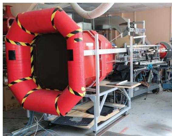
Сверху – сверхзвуковая импульсная аэродинамическая труба ИАДТ-50 для исследования горения в высокоскоростном потоке. Снизу – малотурбулентная аэродинамическая труба Д-3 для исследования течения в пограничных слоях
