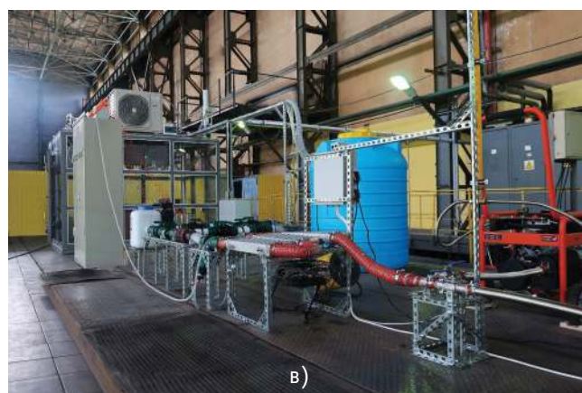
Экспериментальная установка для культивирования микроводорослей в атмосфере газов контролируемого состава. а) газовая камера с размещенными в ней фотобиореакторами; б) цилиндрические фотобиореакторы со светодиодной системой освещения; в) газовое оборудование для подачи газов в газовую камеру с размещенными в ней фотобиореакторами.
