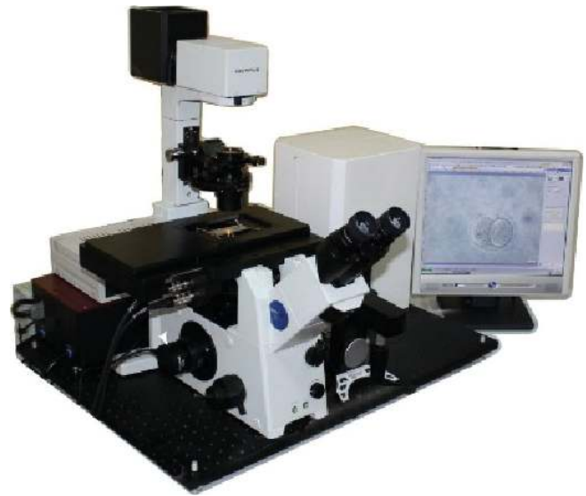
Фемтосекундный лазерный скальпель-оптический пинцет
