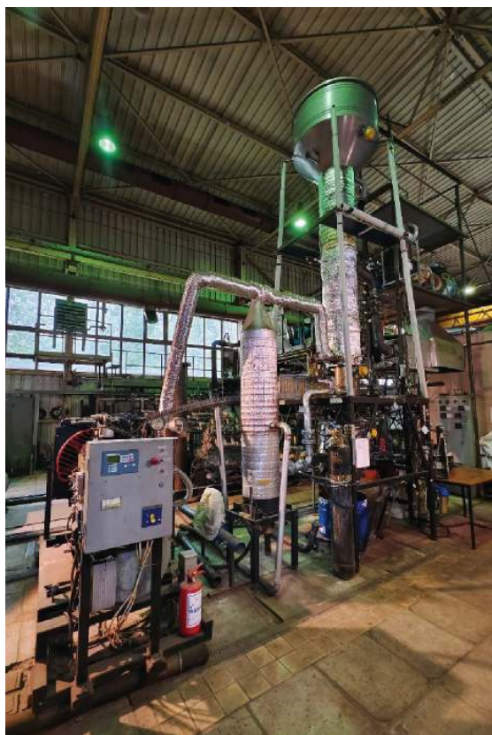
Комплекс для торрефикации гранулированной биомассы
