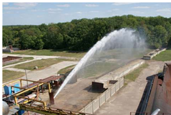
Испытания в качестве автономного источника энергоснабжения для системы пожаротушения
