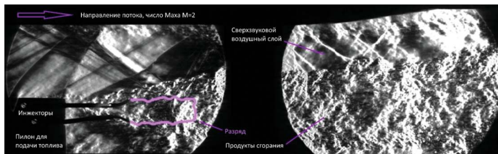
Теневая визуализация горения этилена в модельной камере сгорания прямоточного двигателя, стимулированного разрядом постоянного тока
