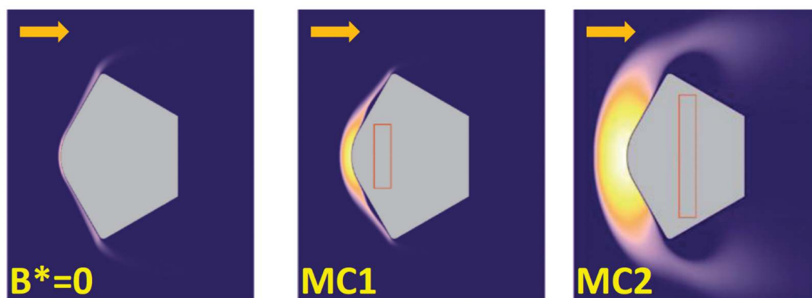
МГД-снижение тепловых нагрузок на поверхности летательного аппарата Stardust, предназначенного для исследования кометы Вильда 2. MC1 и MC2 – магнитная конфигурация 1 и 2, прямоугольник – схематическое изображение магнита
