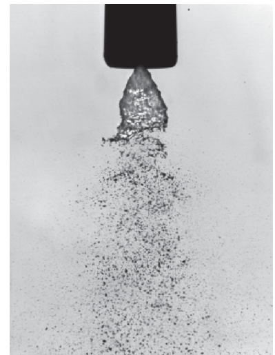
Мгновенная теневая фотография распыла жидкости с помощью вихревой форсунки в неподвижном воздухе
