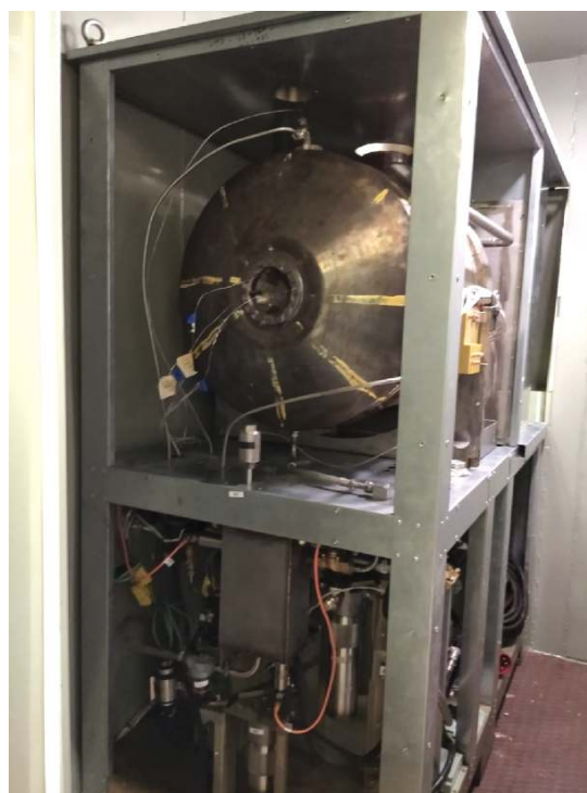
Опытный образец микро-ГТУ мощностью 30 кВт
