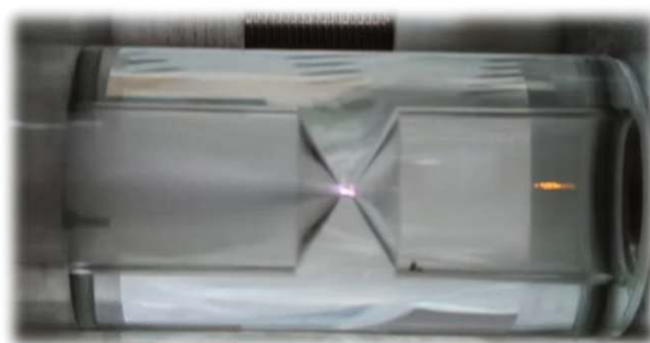
Многопузырьковая сонолюминесценция глицерина (слева) и гидродинамическая люминесценция воды (сверху) – удобный инструмент для исследования параметров кавитирующих полостей спектральными методами
