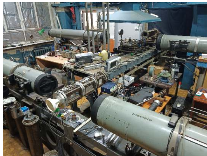
Ударная труба УТ-3 с системой диагностики
