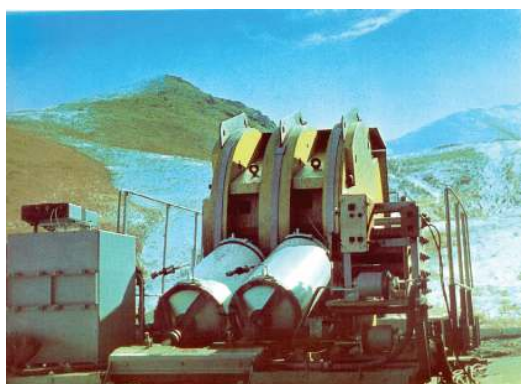
Импульсный МГД-генератор «Памир» на полигоне «ИВТАН-2» (Научная станция РАН, Киргизия, Северный Тянь-Шань) для электромагнитного мониторинга земной коры
