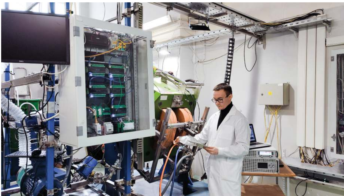
Экспериментальная установка РК-3 по изучению теплогидравлики жидких металлов и расплавов солей в условиях сильного магнитного поля
