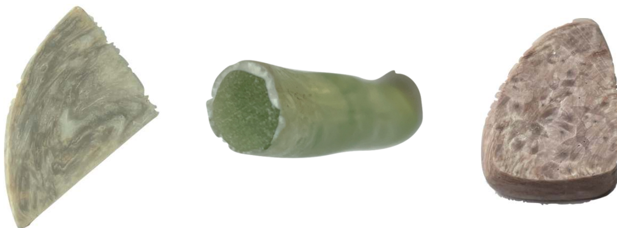
Стеклокристаллические материалы, полученные из отходов переработки сподумена
