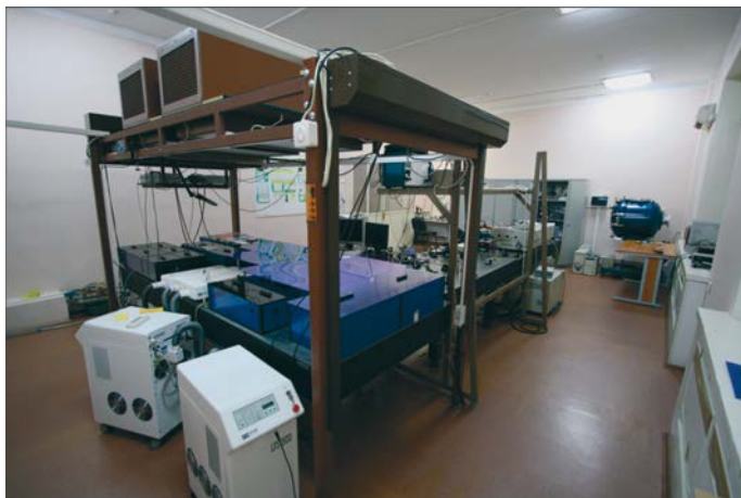
Рис. 1. Фемтосекундная тераваттная лазерная система на основе кристалла хром-форстерита.
