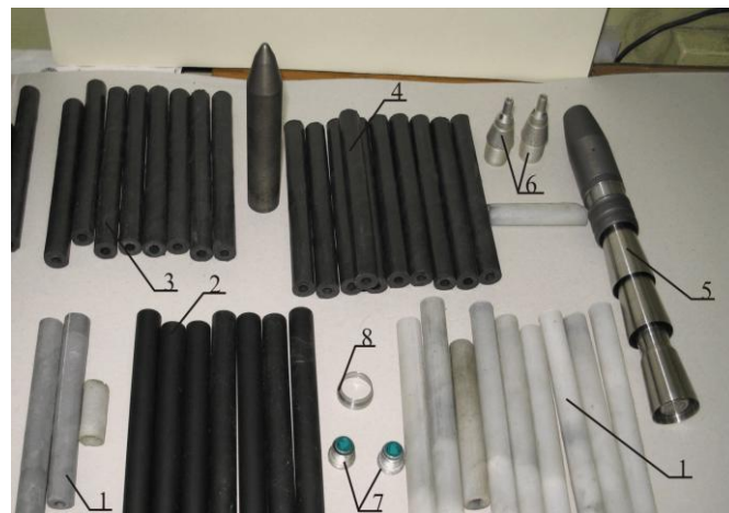
1-ТК; 2-ТАИК; 3-ТВК; 4-ТТіКА; 5-РМЭ-30 на ТК и ТМК; 6-наконечник МЭ-30; 7-пирозапалы; 8-сопло встречных струй КВС.
