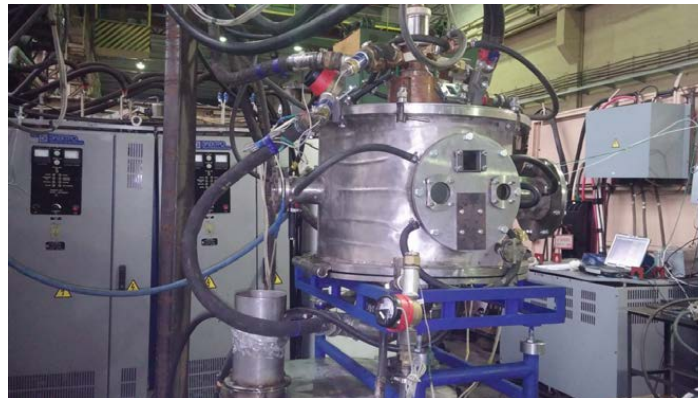
Экспериментальные стенды с плазмотронами 40 кВт и 500 кВт
