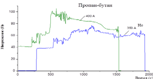
Зависимость напряжения и тока разряда плазмотрона от времени при введении газообразного источника углерода
