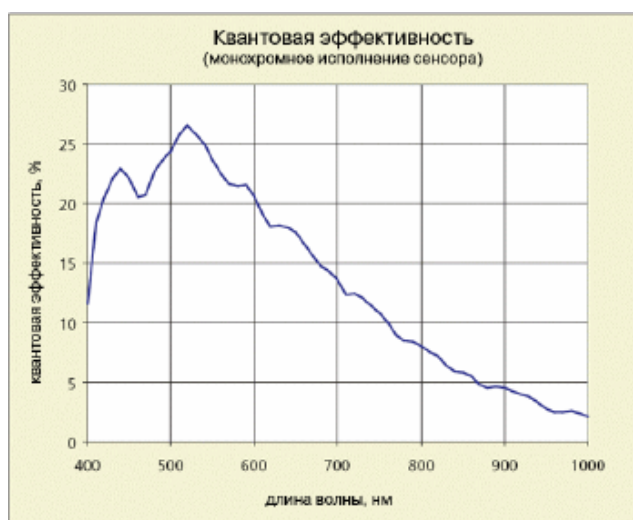
Рис. 2.2.7.3. Спектральная чувствительность камеры Motion Xtra N3 и камеры VS Fast
