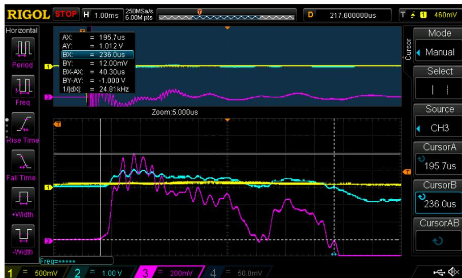
Рисунок 3.31 — Осциллограмма сигнала датчика давления (фиолетовая кривая), по которой определялась амплитуда  $V_{sw}$
