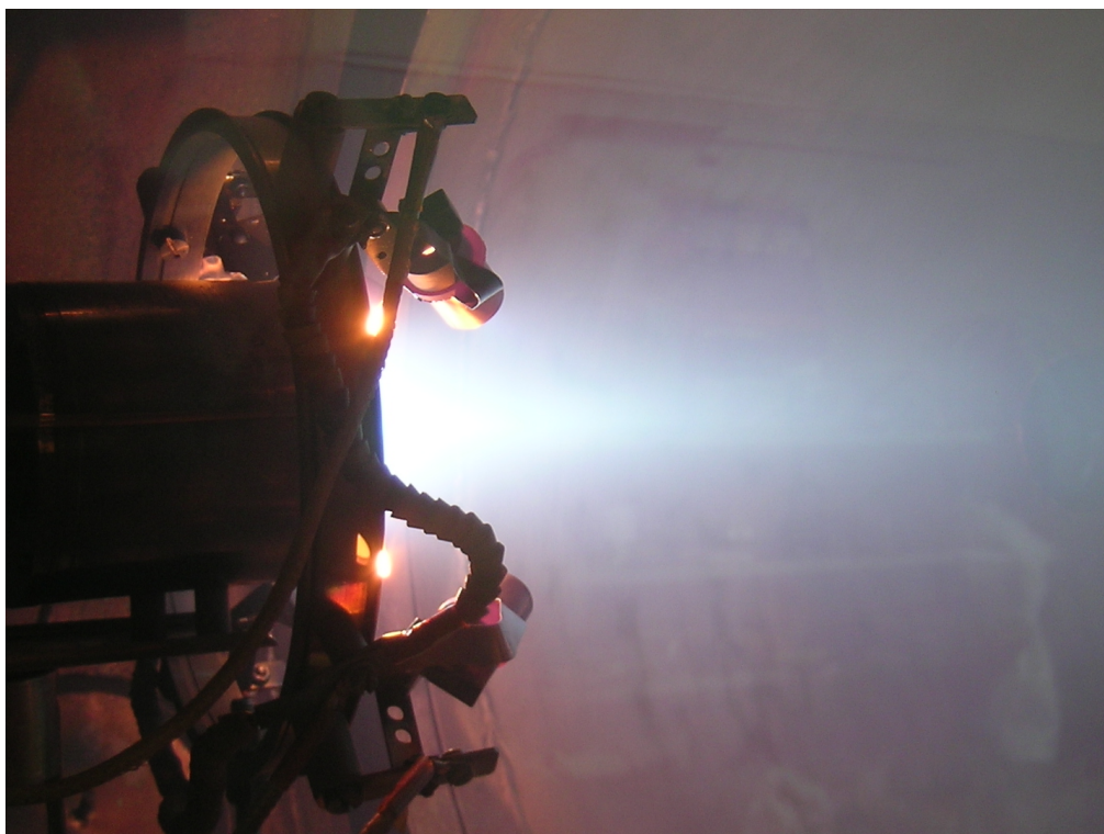
Рисунок 2.2. Фотография макета ХРДПУ с установленным блоком катодов-компенсаторов.
