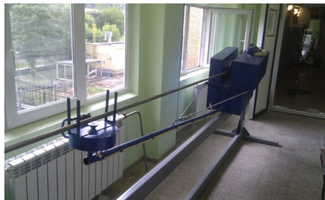
Мобильная установка сбоя гололеда на проводах ВЛ
