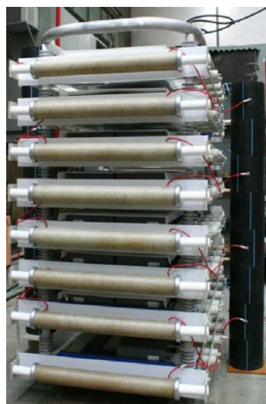
Секция ГИН, U_{\text{вых}}=500\text{кВ} на нагрузку 25 Ом и 50 мкГн
