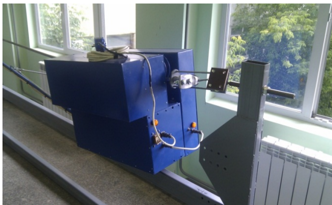
Мобильная установка сбоя гололеда на проводах ВЛ
